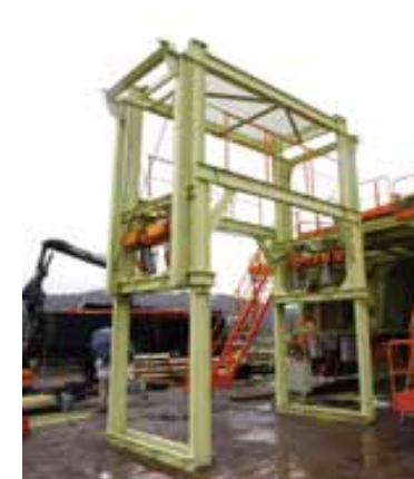
専用架台昇降装置
