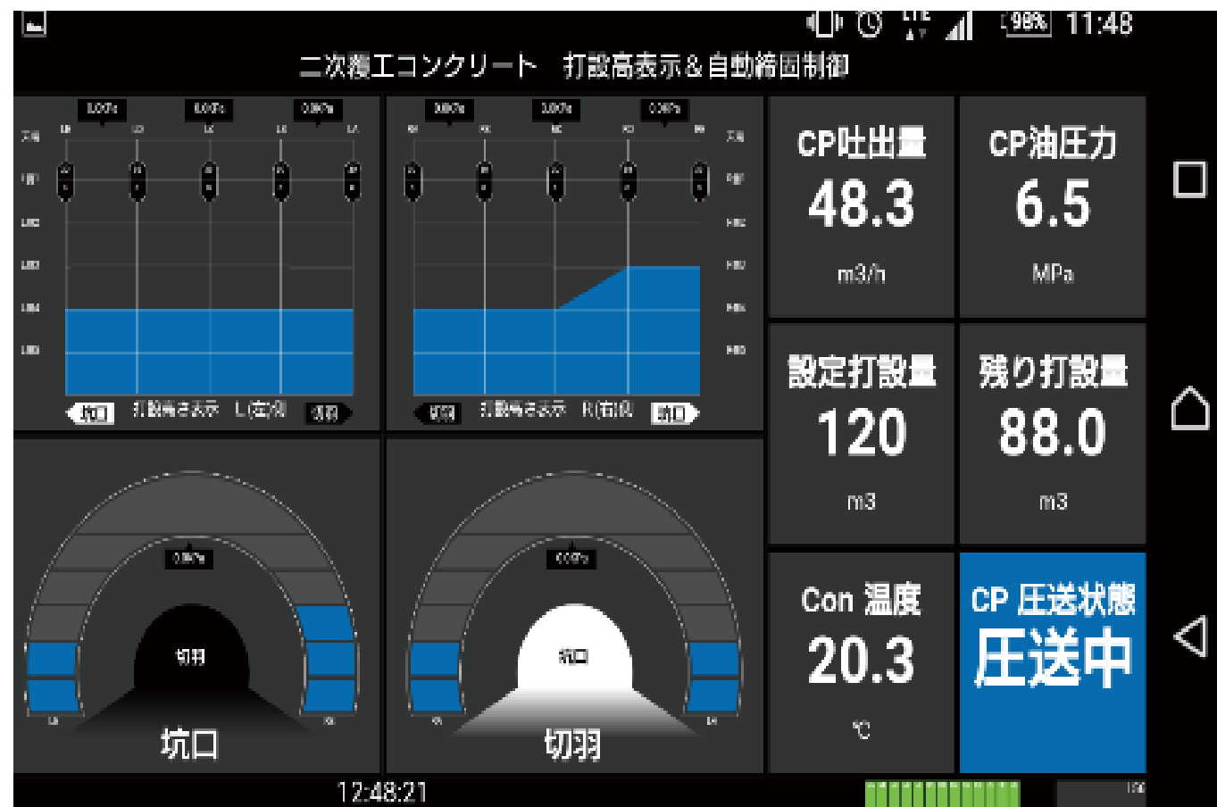
打設中のモニター画面
