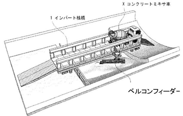
図-2 新工法(ベルコン打設)
